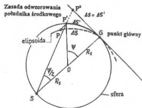
Rys. 6.2. Zasada odwzorowania południka środkowego: łuk \Delta s rozciągamy na sferze o promieniu R_s (stycznej do elipsoidy w punkcie głównym), a następnie stosujemy rzut stereograficzny
